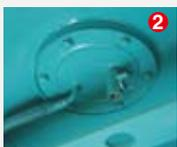
2 Para facilitar la limpieza del depósito de combustible, la válvula de drenaje de combustible equipado con un reborde en la parte inferior.
