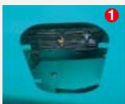
1 Una válvula de drenaje rápido, que no requiere de herramientas, se ofrece como equipamiento de serie.
