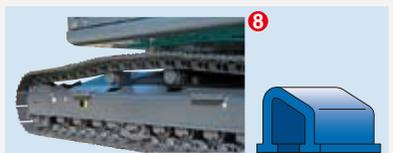
8 Diseño especial del bastidor de orugas se limpia fácilmente de barro.
