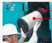
El elemento de gran capacidad, cuenta con una estructura de doble filtro que mantiene el motor en marcha limpio, incluso en entornos con mucho polvo.
