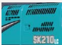
Las aberturas de ventilación para temperaturas tropicales
